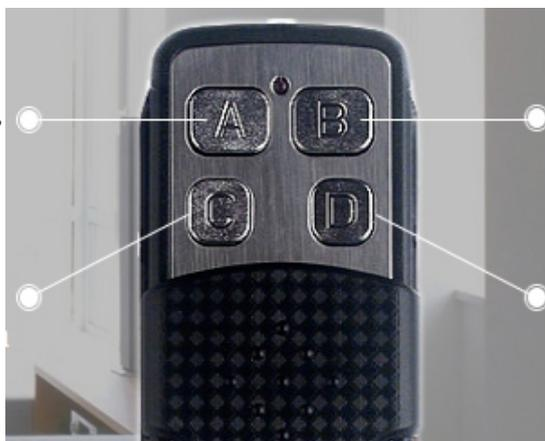
**B** - режим вкл/выкл вентилятор мин. скорость + нагреватель (горит 2 и 4 сенсор)
